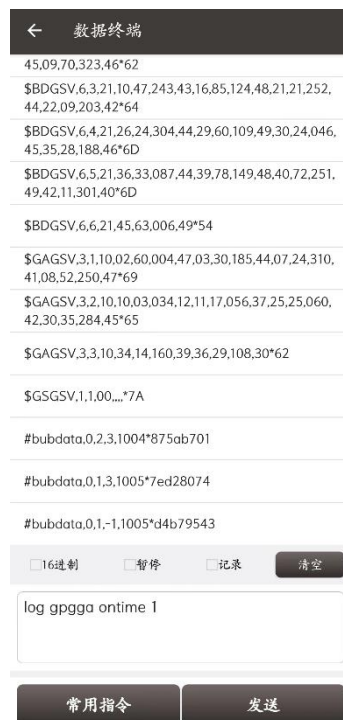
图 3.17 在天硕测量应用程序的数据终端中输入命令
