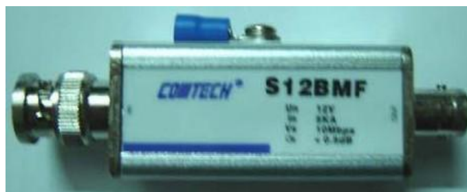
图 7.4 通讯电缆避雷器
