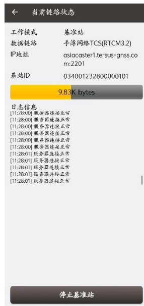
图 6.10 基准站正在发送差分改正
