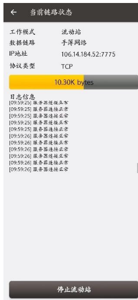
图 6.5 流动站正在接收差分改正
