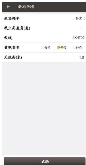
图 6.18 静态测量配置
