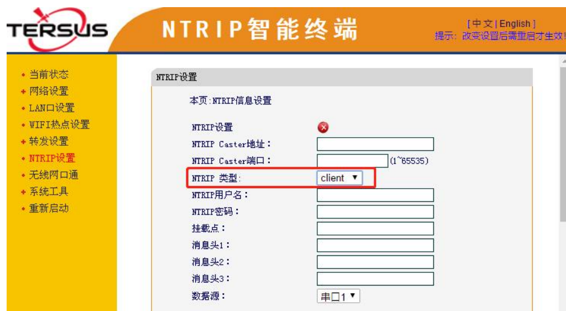
图 4.2 GeoBee30 工作为 Ntrip 客户端模式
