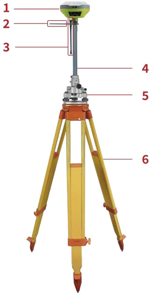
图 4.2 基准站 - 内置电台
