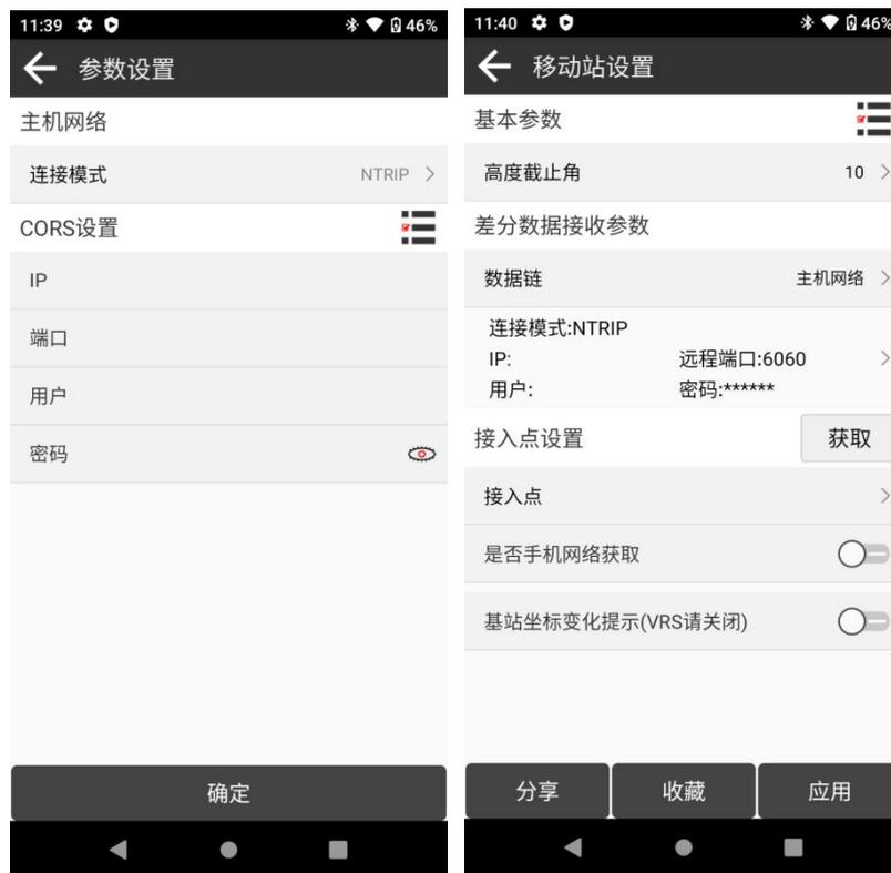
图 4.12 移动站配置 - 主机网络 (Ntrip)
