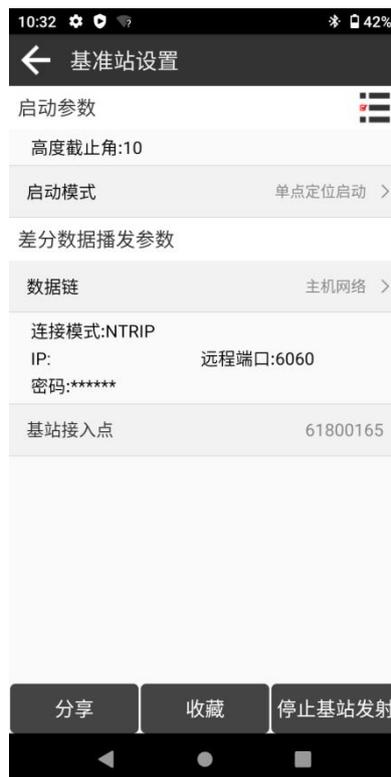
图 4.7 基准站配置 - 主机网络
