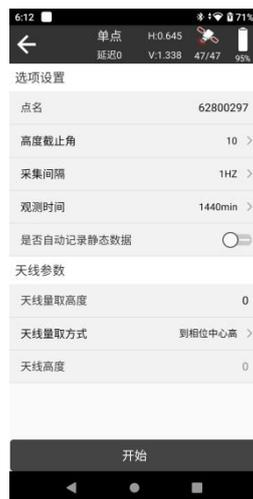
图 4.16 静态测量配置
