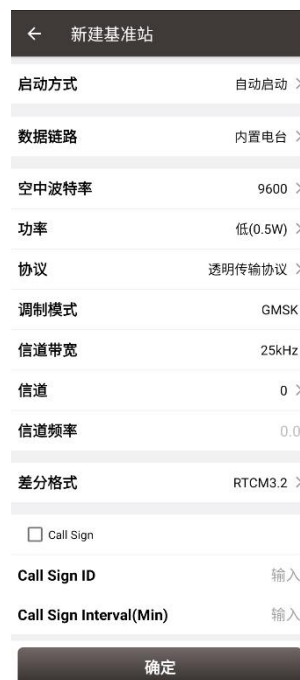
图 3.30 Oscar 基站自启动 – 内置电台
