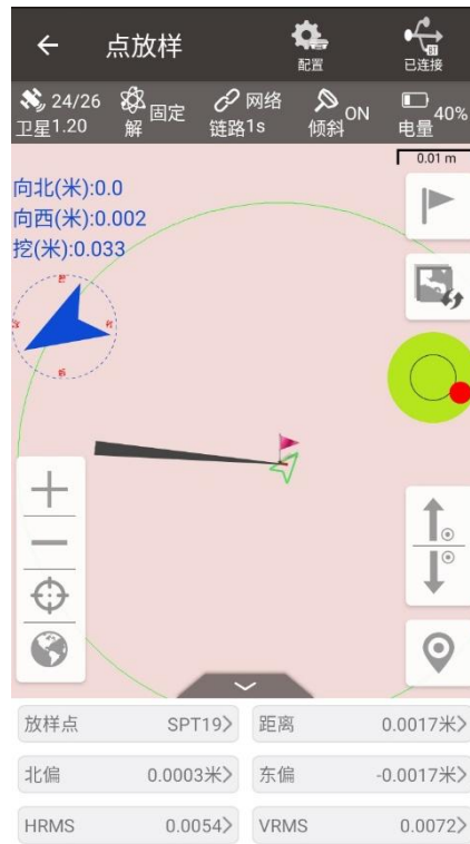
图 4.28 倾斜补偿开启时进行点放样
