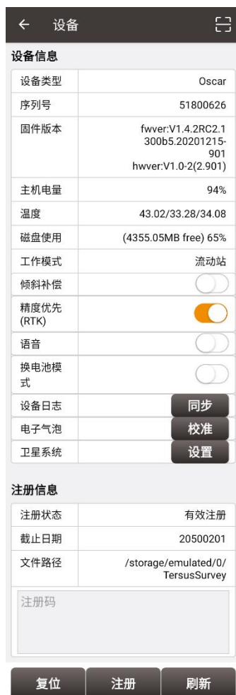
图 4.24 设备信息界面开启倾斜补偿
