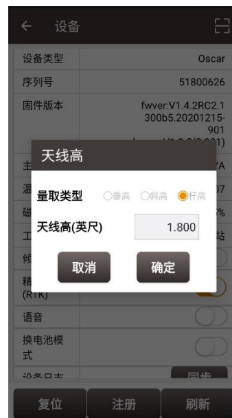
图 4.25 打开倾斜软件提示天线高设置
